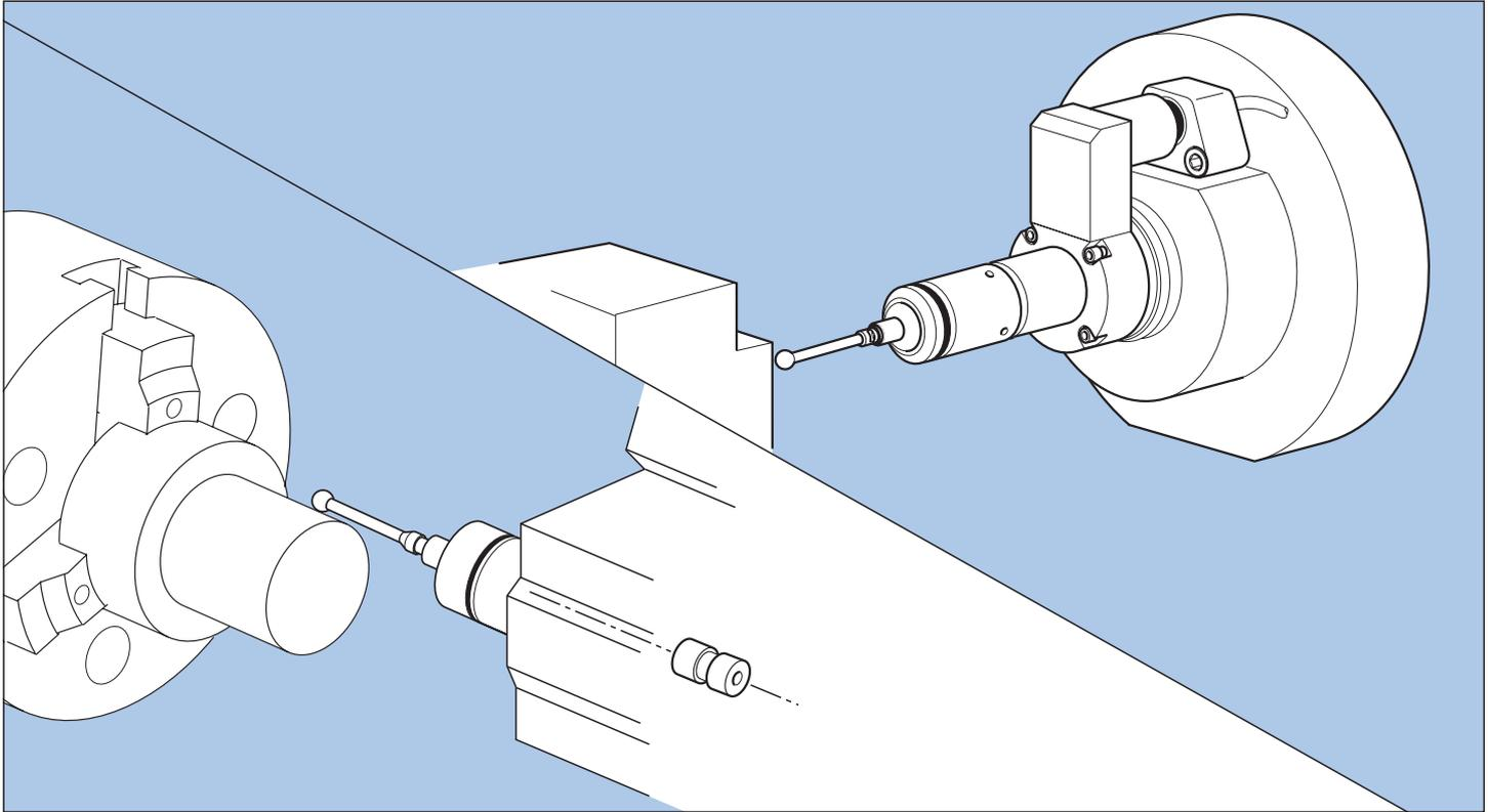
Das HF-Luftspalt Übertragungssystem ermöglicht die Signalweiterleitung über eine oder zwei Trennstellen.
