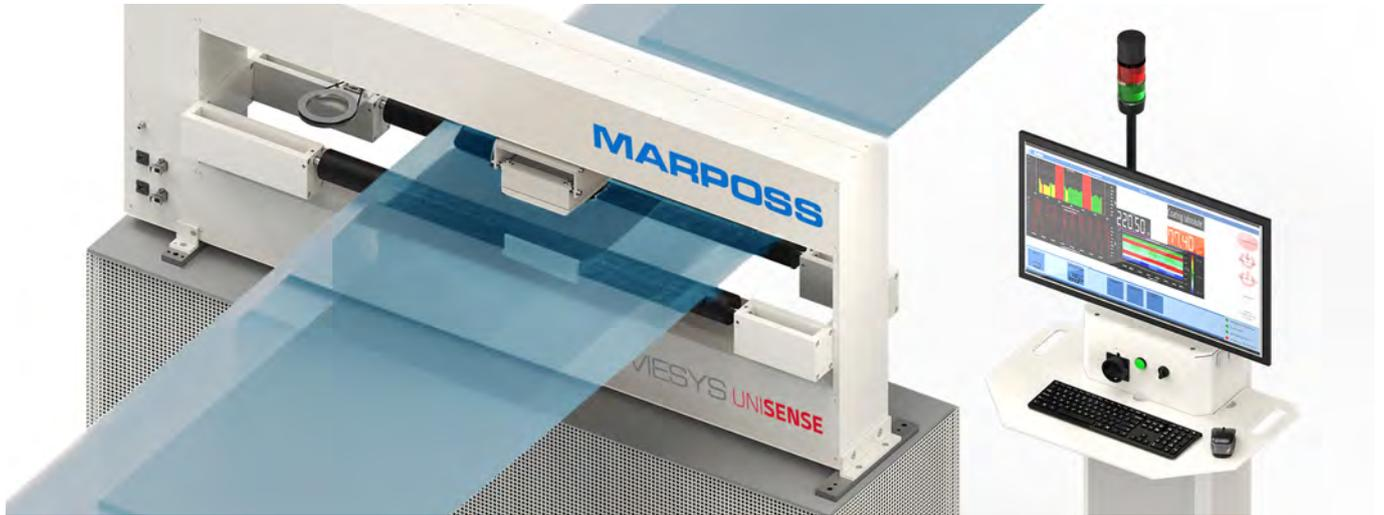
该水平扫描传感器的测量支架可为C形或O形，测量方案简单实用，精度高，可测量湿态和干态下的金属箔的面密度或厚度。O形设计通用性强，广泛用于卷材生产的测量应用，而C形设计则是窄幅卷材测量的理想选择，可在不同应用场景下确保达到测量的高精度。
