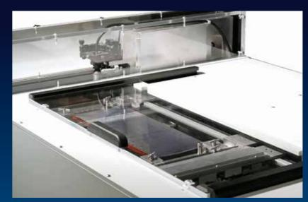
리튬 이온 배터리 분석을 위해 특별히 설계된 Lab Sense는 무게, 두께 및 밀도를 정확하게 측정할수 있는 다양한 센서를 결합하였습니다. 이 시스템은 완벽한 품질 관리 시스템을 추구하는 고객의 요구에 부응하여 탄생했습니다. 당사 초음파 기술 선구자로서 평량(basic weight) 및 마르포스 그룹내 공초점 기술이 조합된 솔루션은 배터리 포일의 형상을 완벽하게 추적하여 강력하고 정확한 품질 관리 시스템을 제공합니다.
