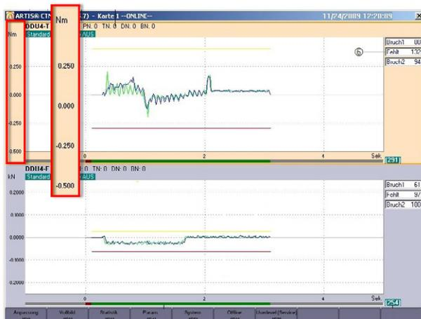
DDU ローターと DDU ステーターは、回転式工具と固定式工具を非接触でモニタリングするセンサーシステムを構成します。このシステムは、関連する測定トランスデューサーと組み合わせて、あらゆる ARTIS 工具 / プロセスモニタリングシステムとともに使用されます。図は、CTM システムでの使用例を示しています。
